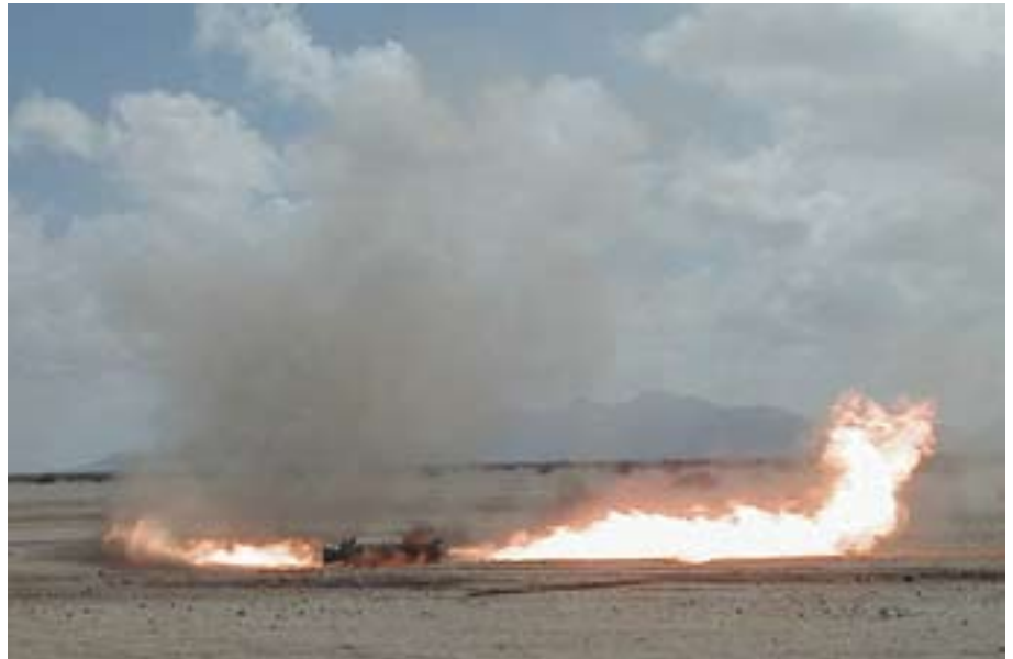
Afbrænding af raketmotor på et SA-2 missil.
