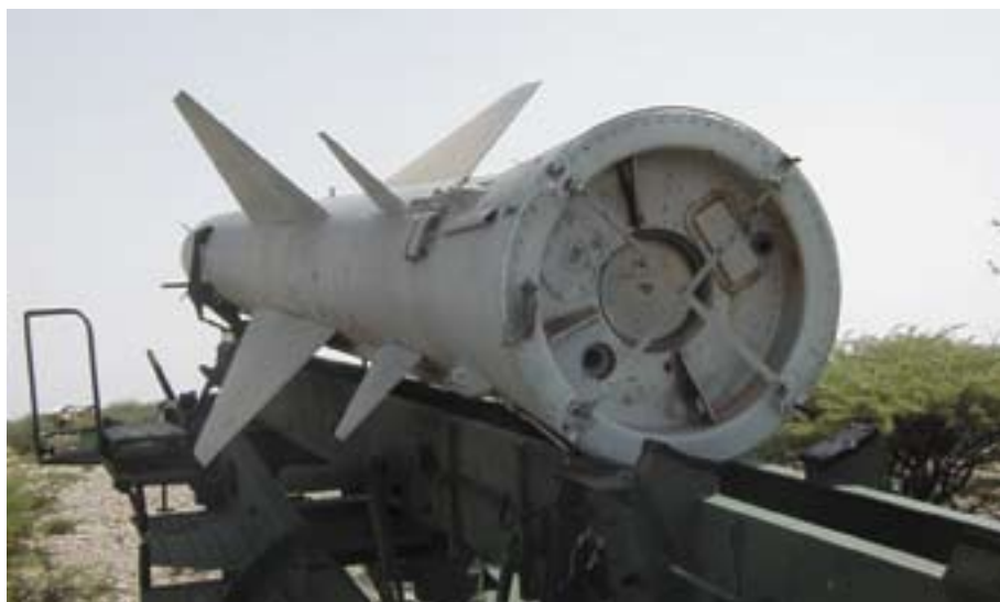
Et SA-2 jord til luft missil på affyrringsrampe. Ledninger til tændmekanismer og detonatorer er klippet. Der er ingen lækager på tryktanke, så missilerne er stort set intakte.
