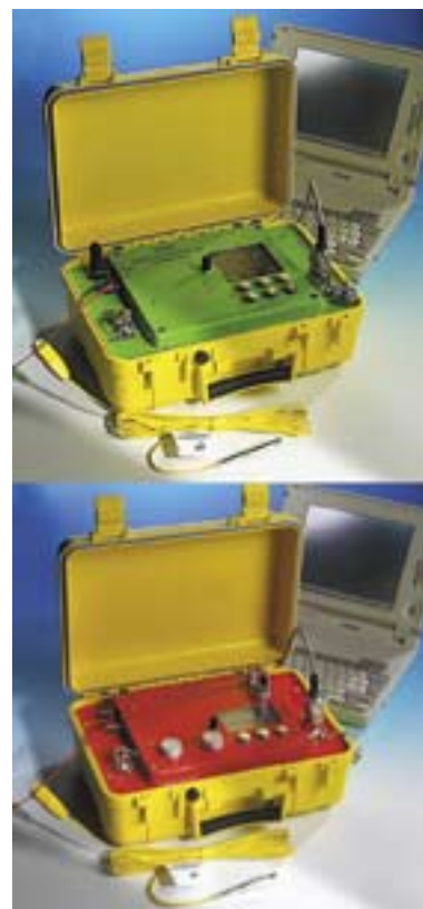
Loggning och upptändning sker av säkerhetsskäl med två olika apparater.
