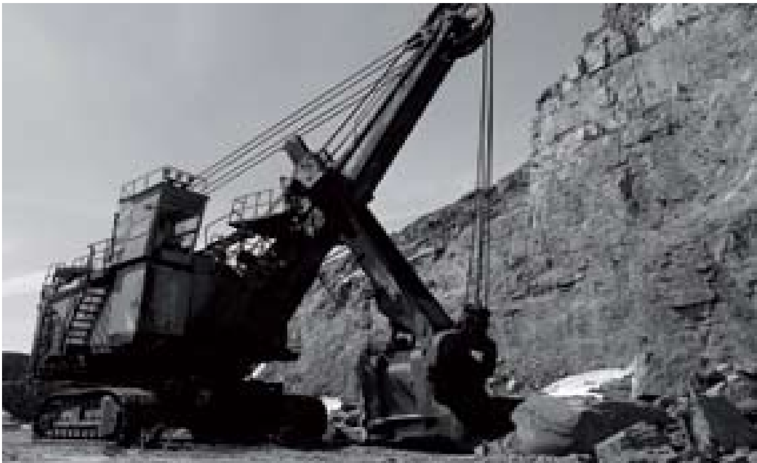
En av Rana Grubers gamle gravemaskiner står vakt i Kvannevang dagbrudd. PH 2100B-maskina er laget i Japan, den veier 450 tonn og kan laste 13 kubikk i slengen. Graveren drives av elektrisk strøm
