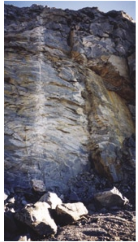
3. Borrhål med synliga brännpipor där detonationen har gått från botten och upp och från toppen och ner. Vi ser också delar av borrhålet där det inte varit någon detonation.
