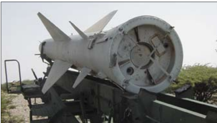
En SA-2 robot på avfyringsrampen. Ledningarna till tändmekanismer och detonatorer är avklipppta. Det är ingen läckage på trycktanken, så missilerna är i stort sett intakta.
