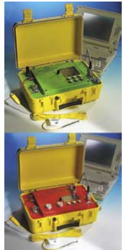
Loggning och upptändning sker av säkerhetsskäl med två olika apparater.
