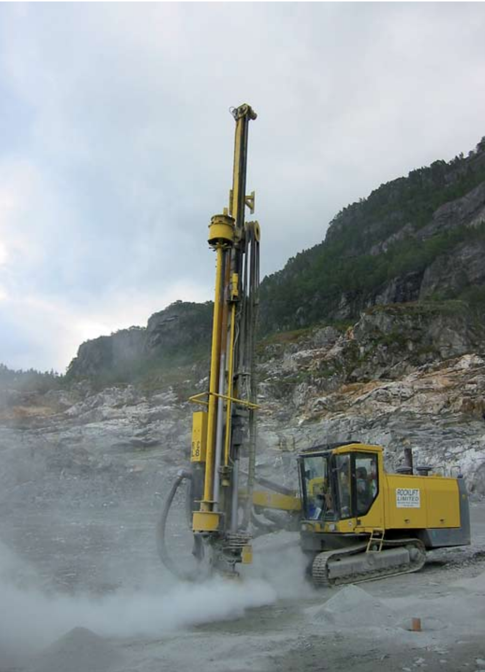
Borring i sylta vid Norsk Stein på Jelsa Atlas Copco Roc L8 Senkborrhög
