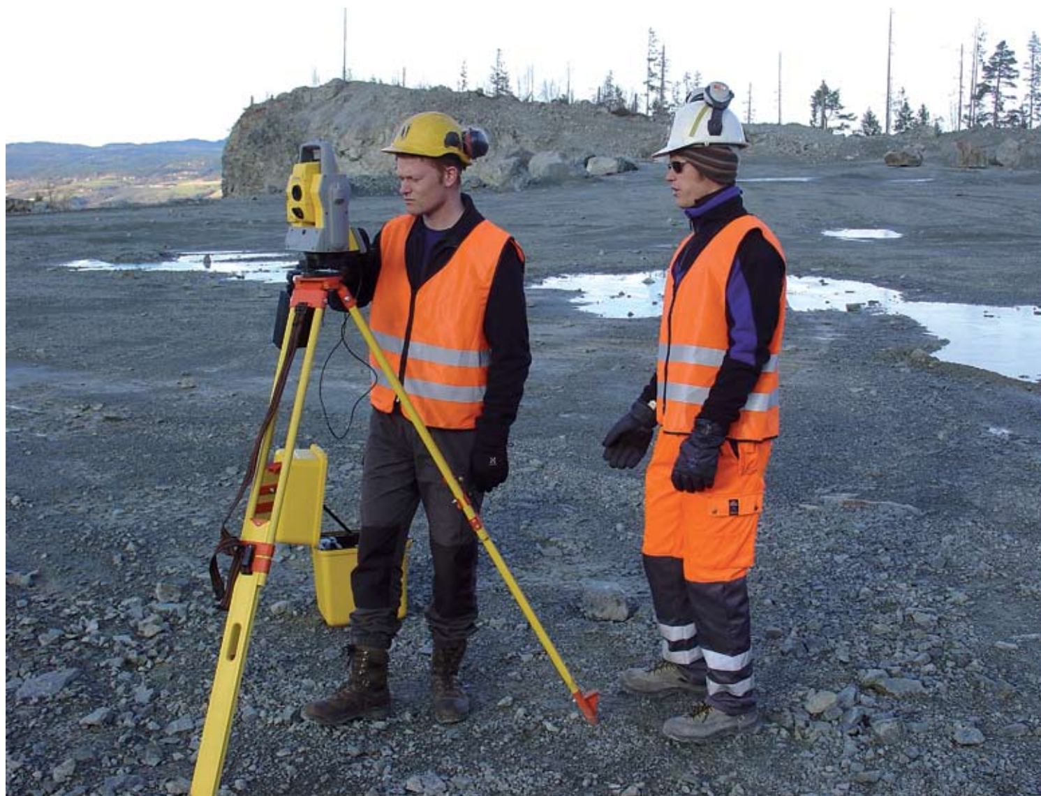
Loggning av borrhålsavvikelse och positionsbestämning av borrhålskoordinater kan ge reducerad sannolikhet för påborring
